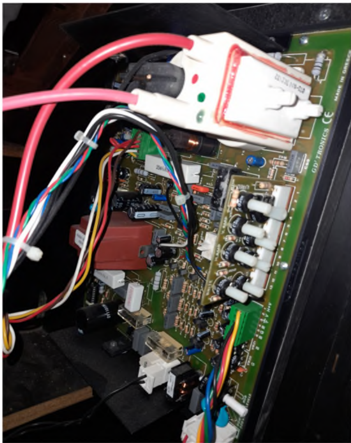
Το σασί μιας οθόνης arcade βιδωμένο στο πλαίσιο τοίχωμα της καμπίνας.
